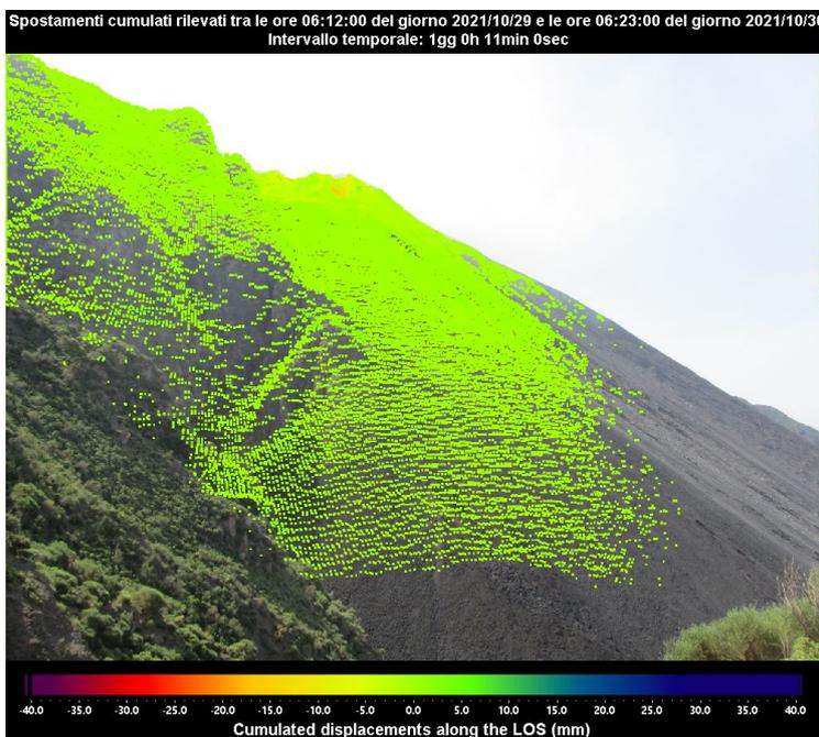
**Figura 2 -** Mappa cumulata degli spostamenti registrata dal sistema GB-InSAR NE400 riferito al tempo di 1 giorno e 11 minuti dalle ore 06:12 UTC (08:12 ore locali) del 29 ottobre 2021 alle ore 06:23 UTC (08:23 ore locali) del 30 ottobre 2021.
