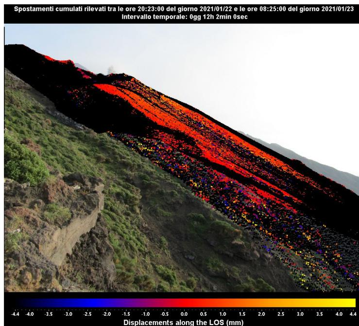
Figura 3 - Interferogramma SAR registrato dal sistema GB-InSAR NE190 riferito al tempo di 12 ore e 2 minuti, dalle ore 20:23 UTC (21:23 ore locali) del 22 gennaio 2021 alle ore 08:25 UTC (09:25 ore locali) del 23 gennaio 2021.
