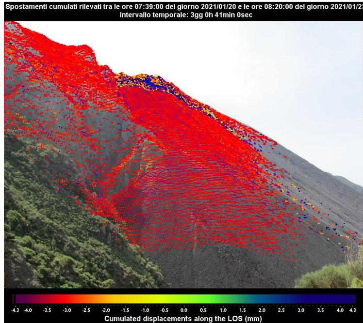
Figura 2 - Interferogramma SAR registrato dal sistema GB-InSAR NE400 riferito al tempo di 3 giorni e 41 minuti, dalle ore 07:39 UTC (08:39 ore locali) del 20 gennaio 2021 alle ore 08:20 UTC (09:20 ore locali) del 23 gennaio 2021.
