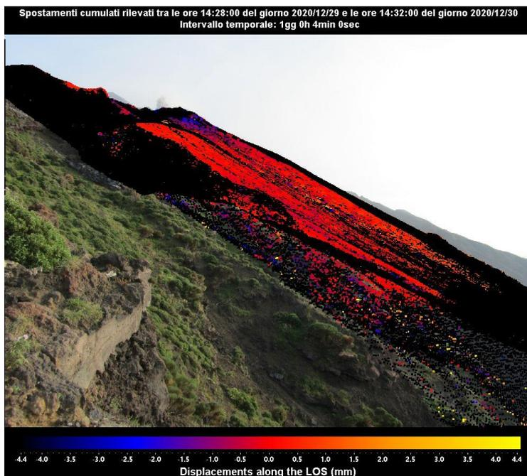
Figura 3 - Interferogramma SAR registrato dal sistema GB-InSAR NE190 riferito al tempo di 1 giorno e 4 minuti, dalle ore 14:28 UTC (15:28 ore locali) del 29 dicembre 2020 alle ore 14:32 UTC (15:32 ore locali) del 30 dicembre 2020.
