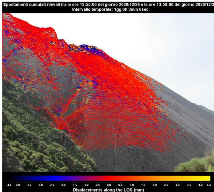
Figura 2 - Interferogramma SAR registrato dal sistema GB-InSAR NE400 riferito al tempo di 1 giorno e 3 minuti, dalle ore 13:55 UTC (14:55 ore locali) del 29 dicembre 2020 alle ore 13:58 UTC (14:58 ore locali) del 30 dicembre 2020.
