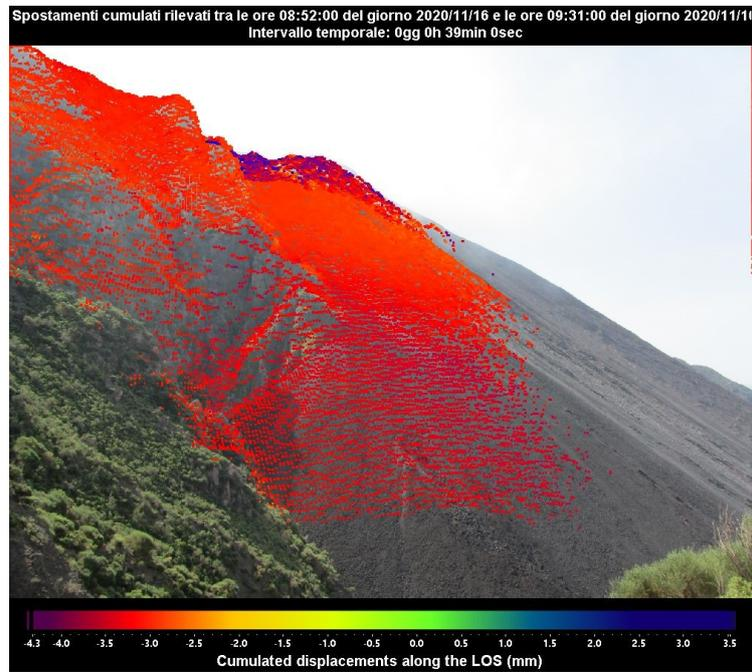
**Figura 2 - Interferogramma SAR registrato dal sistema GB-InSAR NE400 riferito al tempo di 39 minuti, dalle ore 08:52 UTC (09:52 ore locali) alle ore 09:31 UTC (10:31 ore locali) del 16 novembre 2020.**
