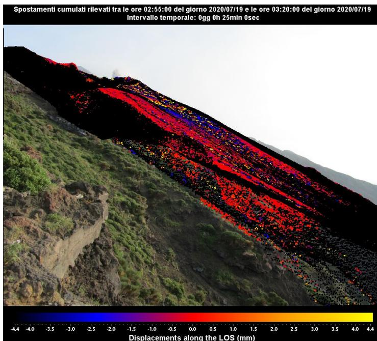
Figura 2 - Interferogramma SAR registrato dal sistema GB-InSAR NE190 riferito al tempo di 25 minuti, dalle ore 02:55 UTC (04:55 ore locali) alle ore 03:20 UTC (05:20 ore locali) del 19 luglio 2020.
