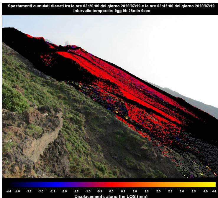
Figura 3 - Interferogramma SAR registrato dal sistema GB-InSAR NE190 riferito al tempo di 25 minuti, dalle ore 03:20 UTC (05:20 ore locali) alle ore 03:45 UTC (05:45 ore locali) del 19 luglio 2020.
