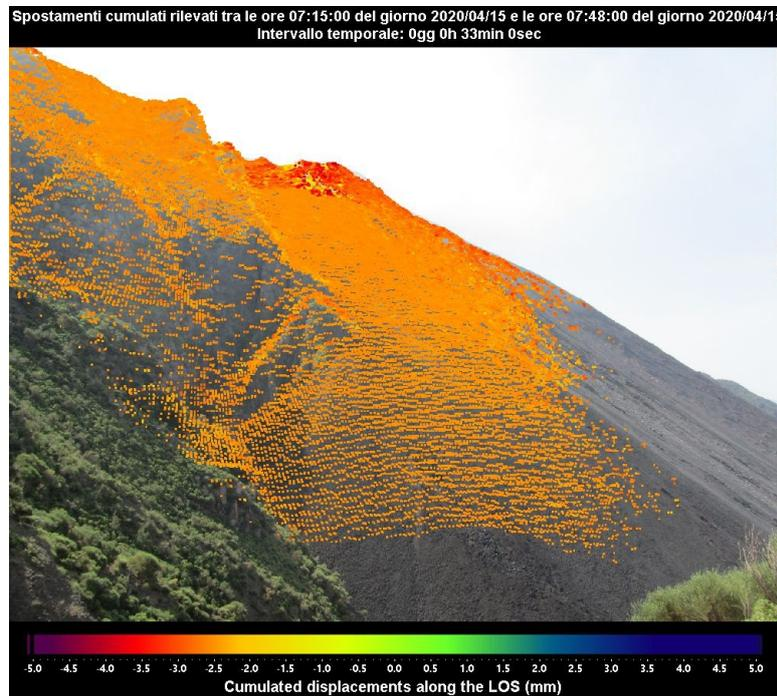
Figura 2 - Mappa degli spostamenti cumulati registrati dal sistema GB-InSAR NE400 riferito al tempo di 33 minuti, dalle ore 07:15 UTC (09:15 ore locali) alle ore 07:48 UTC (09:48 ore locali) del 15 aprile 2020.
