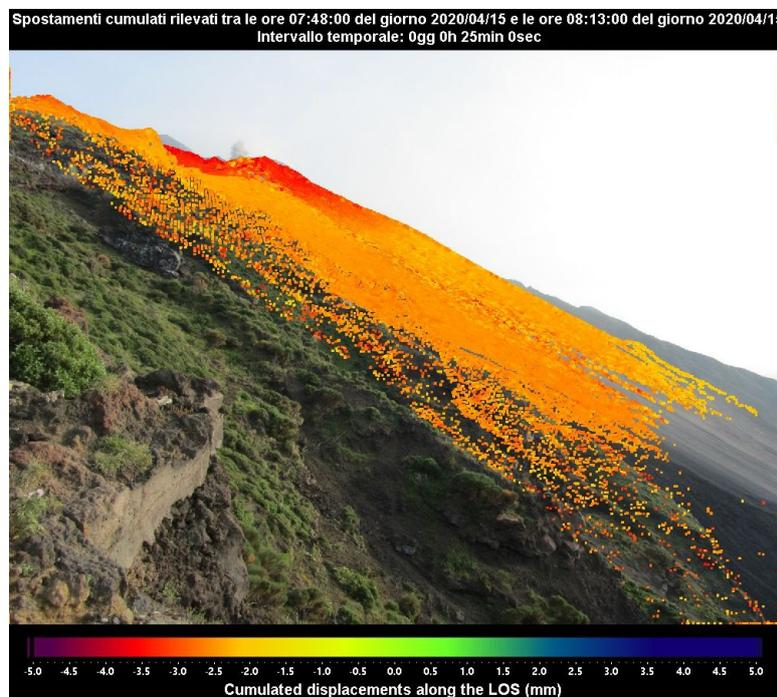
Figura 3 - Mappa degli spostamenti cumulati registrati dal sistema GB-InSAR NE190 riferito al tempo di 25 minuti, dalle ore 07:48 UTC (09:48 ore locali) alle ore 08:13 UTC (10:13 ore locali) del 15 aprile 2020.
