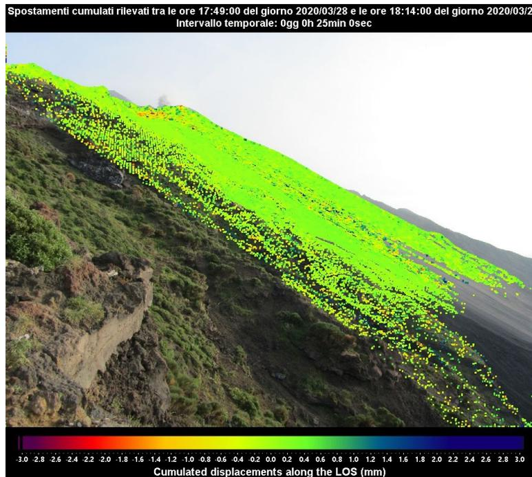
Figura 3 - Mappa degli spostamenti cumulati registrati dal sistema GB-InSAR NE190 riferito al tempo di 17 minuti, dalle ore 17:49 UTC (18:49 ore locali) alle ore 18:14 UTC (19:14 ore locali) del 28 marzo 2020.
