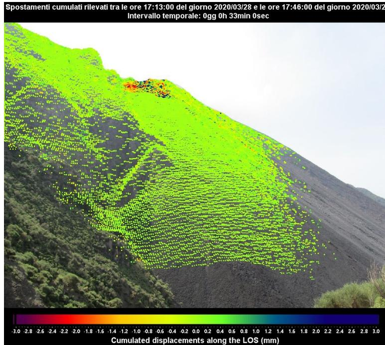
Figura 2 - Mappa degli spostamenti cumulati registrati dal sistema GB-InSAR NE400 riferito al tempo di 33 minuti, dalle ore 17:13 UTC (18:13 ore locali) alle ore 17:46 UTC (18:16 ore locali) del 28 marzo 2020.
