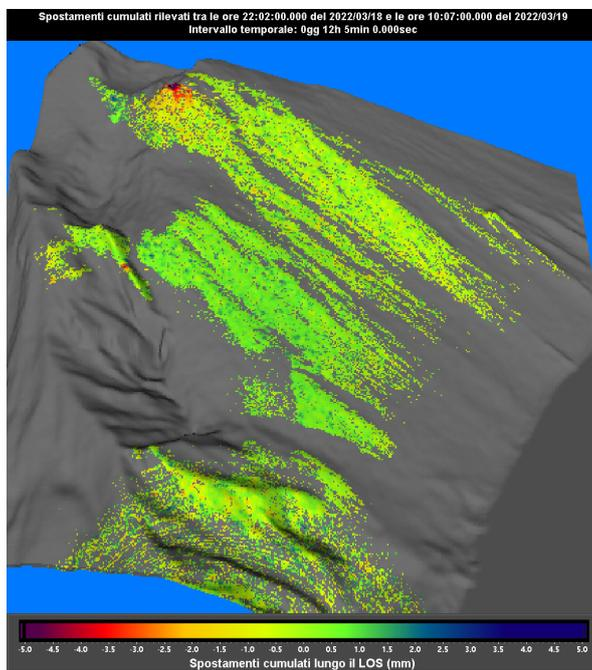
**Figura 2 -** Mappa degli spostamenti cumulati registrata dal sistema GBInSAR NE190 riferita al tempo di 12 ore e 15 minuti dalle ore 22:02 UTC (23:02 ore locali) del 18 marzo 2022 alle ore 10:07 UTC (11:07 ore locali) del 19 marzo 2022.
