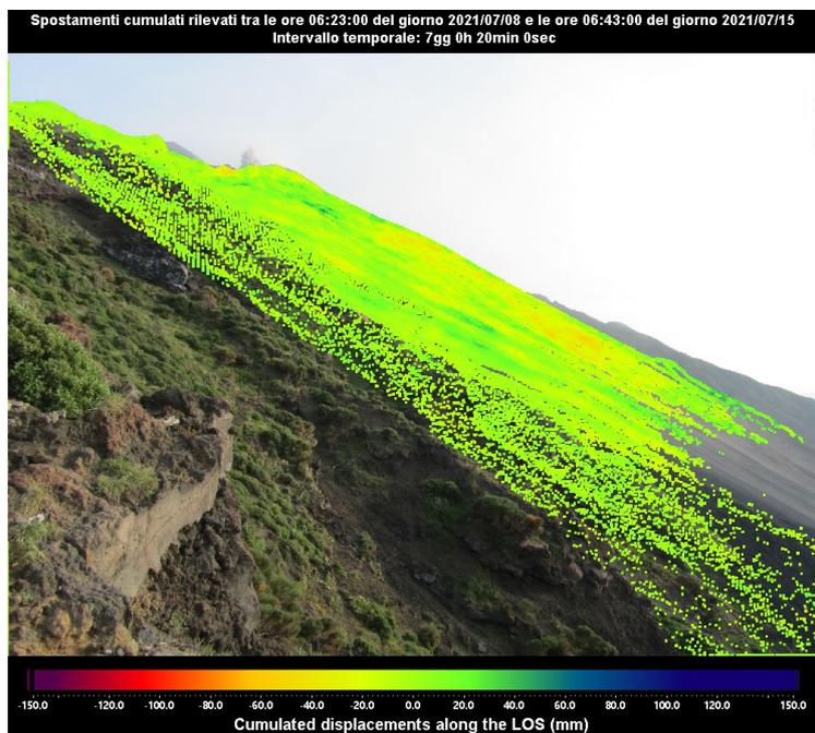
Figura 3 - Mappa degli spostamenti cumulati registrati dal sistema GB-InSAR NE190 riferito al tempo di 7 giorni e 20 minuti, dalle ore 06:23 UTC (08:23 ore locali) del 08 luglio 2021 alle ore 06:43 UTC (08:43 ore locali) del 15 luglio 2021.
