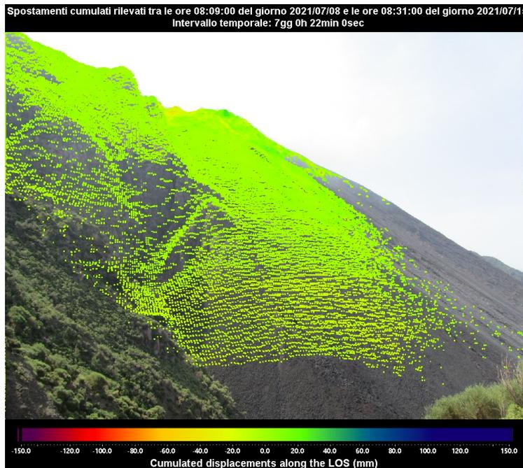
Figura 2 - Mappa degli spostamenti cumulati registrati dal sistema GB-InSAR NE400 riferito al tempo di 7 giorni e 22 minuti, dalle ore 08:09 UTC (10:08 ore locali) del 8 luglio 2021 alle ore 08:31 UTC (10:31 ore locali) del 15 luglio 2021.
