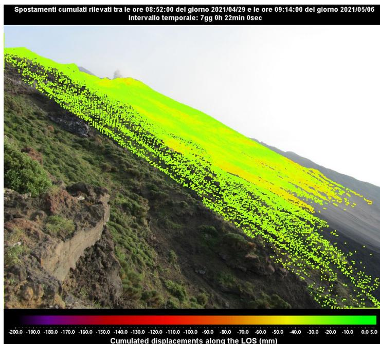
Figura 3 - Mappa degli spostamenti cumulati registrati dal sistema GB-InSAR NE190 riferito al tempo di 7 giorni e 22 minuti, dalle ore 08:52 UTC (10:52 ore locali) del 29 aprile 2021 alle ore 09:14 UTC (10:14 ore locali) del 6 maggio 2021.
