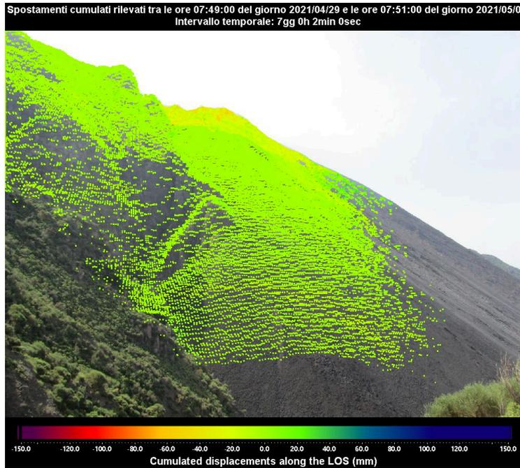
Figura 2 - Mappa degli spostamenti cumulati registrati dal sistema GB-InSAR NE400 riferito al tempo di 7 giorni e 2 minuti, dalle ore 07:49 UTC (09:49 ore locali) del 29 aprile 2021 alle ore 07:51 UTC (09:51 ore locali) del 6 maggio 2021.
