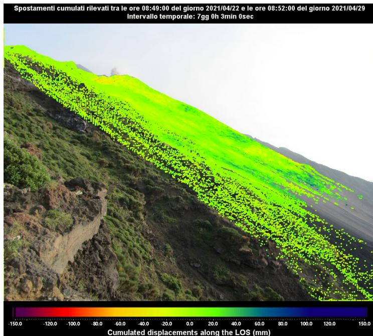
Figura 3 - Mappa degli spostamenti cumulati registrati dal sistema GB-InSAR NE190 riferito al tempo di 7 giorni e 3 minuti, dalle ore 08:49 UTC (10:49 ore locali) del 22 aprile 2021 alle ore 08:52 UTC (10:52 ore locali) del 29 aprile 2021.
