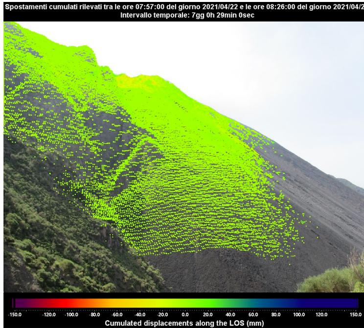
Figura 2 - Mappa degli spostamenti cumulati registrati dal sistema GB-InSAR NE400 riferito al tempo di 7 giorni e 29 minuti, dalle ore 07:57 UTC (09:57 ore locali) del 22 aprile 2021 alle ore 08:26 UTC (10:26 ore locali) del 29 aprile 2021.
