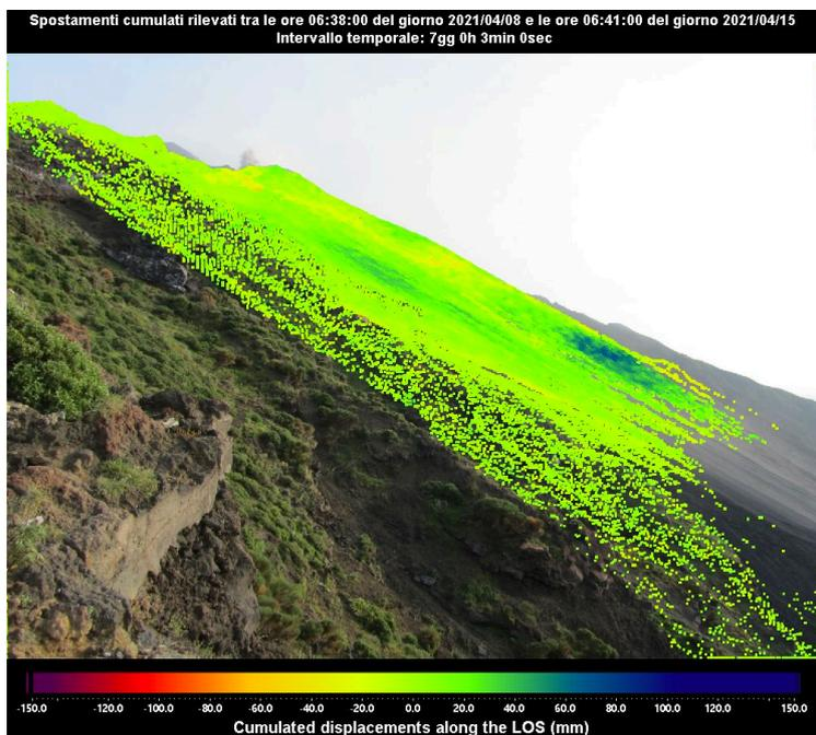
Figura 3 - Mappa degli spostamenti cumulati registrati dal sistema GB-InSAR NE190 riferito al tempo di 7 giorni e 3 minuti, dalle ore 06:38 UTC (08:38 ore locali) del 08 aprile 2021 alle ore 06:41 UTC (08:41 ore locali) del 15 aprile 2021.
