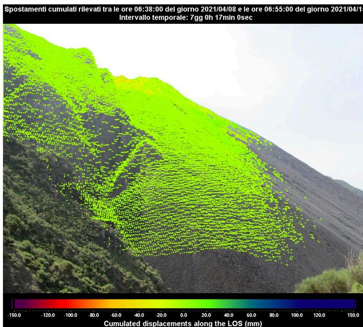
Figura 2 - Mappa degli spostamenti cumulati registrati dal sistema GB-InSAR NE400 riferito al tempo di 7 giorni e 17 minuti, dalle ore 06:38 UTC (08:38 ore locali) del 08 aprile 2021 alle ore 06:55 UTC (08:55 ore locali) del 15 aprile 2021.
