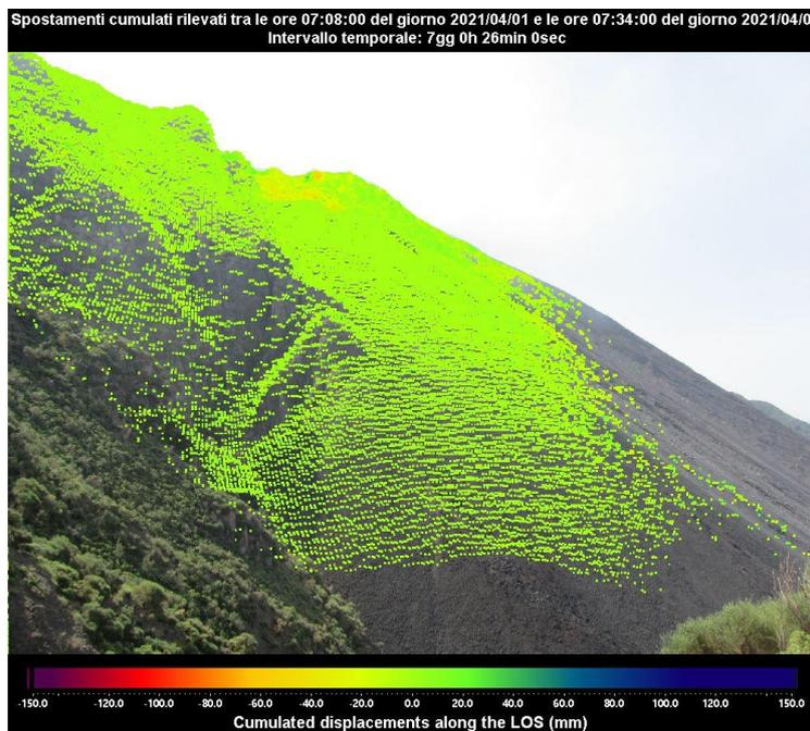
Figura 2 - Mappa degli spostamenti cumulati registrati dal sistema GB-InSAR NE400 riferito al tempo di 7 giorni, dalle ore 07:08 UTC (09:08 ore locali) del 01 aprile 2021 alle ore 07:34 UTC (09:34 ore locali) del 08 aprile 2021.
