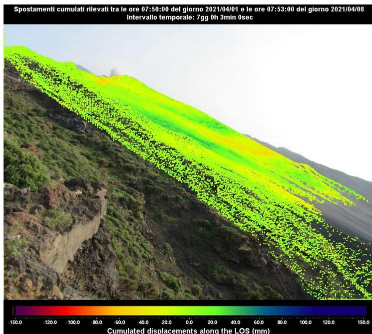
Figura 3 - Mappa degli spostamenti cumulati registrati dal sistema GB-InSAR NE190 riferito al tempo di 7 giorni, dalle ore 07:50 UTC (09:50 ore locali) del 01 aprile 2021 alle ore 07:53 UTC (09:53 ore locali) del 08 aprile 2021.
