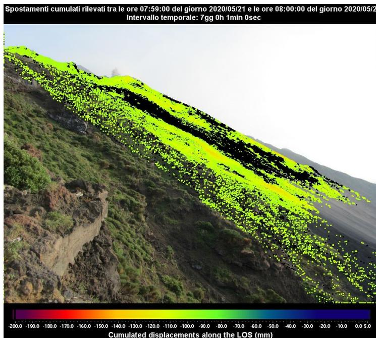
**Figura 3 -** Mappa degli spostamenti cumulati registrati dal sistema GB-InSAR NE190 riferito al tempo di 7 giorni e 1 minuti, dalle ore 07:59 UTC (09:59 ore locali) del 21 maggio 2020 alle ore 08:00 UTC (10:00 ore locali) del 28 maggio 2020.
