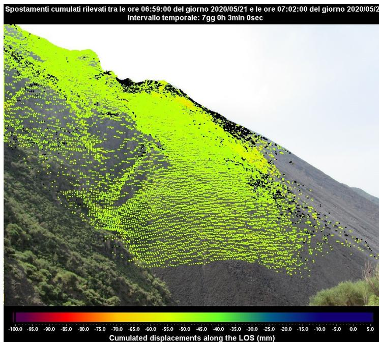
**Figura 2 -** Mappa degli spostamenti cumulati registrati dal sistema GB-InSAR NE400 riferito al tempo di 7 giorni e 3 minuti, dalle ore 06:59 UTC (08:59 ore locali) del 21 maggio 2020 alle ore 07:02 UTC (09:02 ore locali) del 28 maggio 2020.
