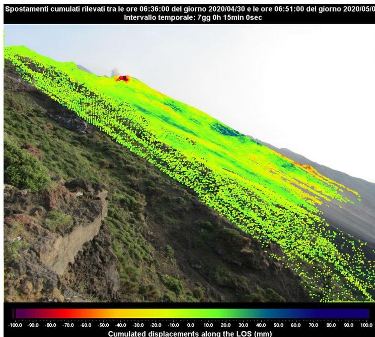
Figura 3 - Mappa degli spostamenti cumulati registrati dal sistema GB-InSAR NE190 riferito al tempo di 7 giorni e 15 minuti, dalle ore 06:36 UTC (07:36 ore locali) del 30 aprile 2020 alle ore 06:51 UTC (07:51 ore locali) del 07 maggio 2020.
