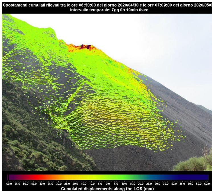
Figura 2 - Mappa degli spostamenti cumulati registrati dal sistema GB-InSAR NE400 riferito al tempo di 7 giorni e 19 minuti, dalle ore 06:50 UTC (07:50 ore locali) del 30 aprile 2020 alle ore 07:09 UTC (08:09 ore locali) del 07 maggio 2020.
