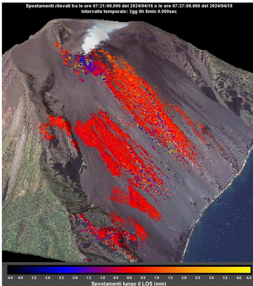
Figura 2 – Interferogramma registrato dal sistema GBInSAR NE190 riferito al tempo di 2 giorni e 6 minuti dalle ore 07:21 UTC (09:21 ora locale) del 16 aprile 2024 alle ore 07:27 UTC (9:27 ore locali) del 18 aprile 2024.
