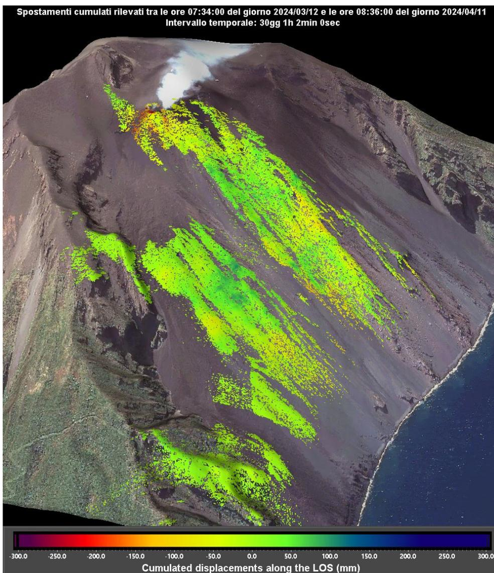
Figura 2 – Mappa degli spostamenti cumulati registrati dal sistema GBInSAR NE190 riferito al tempo di 30 giorni e 1 ore 2 minuti dalle ore 07:34 UTC (09:34 ora locale) del 12 marzo 2024 alle ore 08:36 UTC (10:36 ore locali) del 11 aprile 2024.
