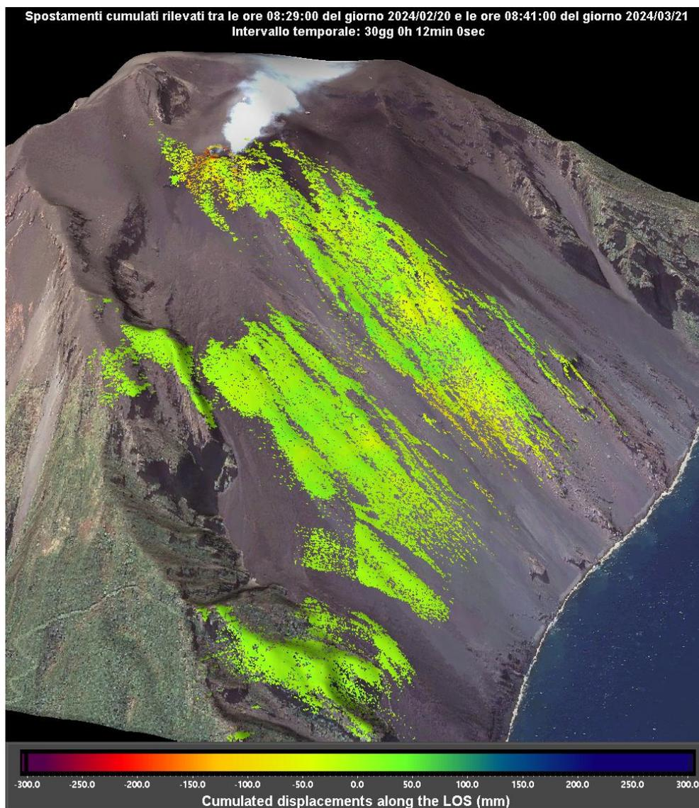
Figura 2 – Mappa degli spostamenti cumulati registrati dal sistema GBInSAR NE190 riferito al tempo di 30 giorni e 12 minuti dalle ore 08:29 UTC (09:29 ora locale) del 20 febbraio 2024 alle ore 08:41 UTC (09:41 ore locali) del 21 marzo 2024.
