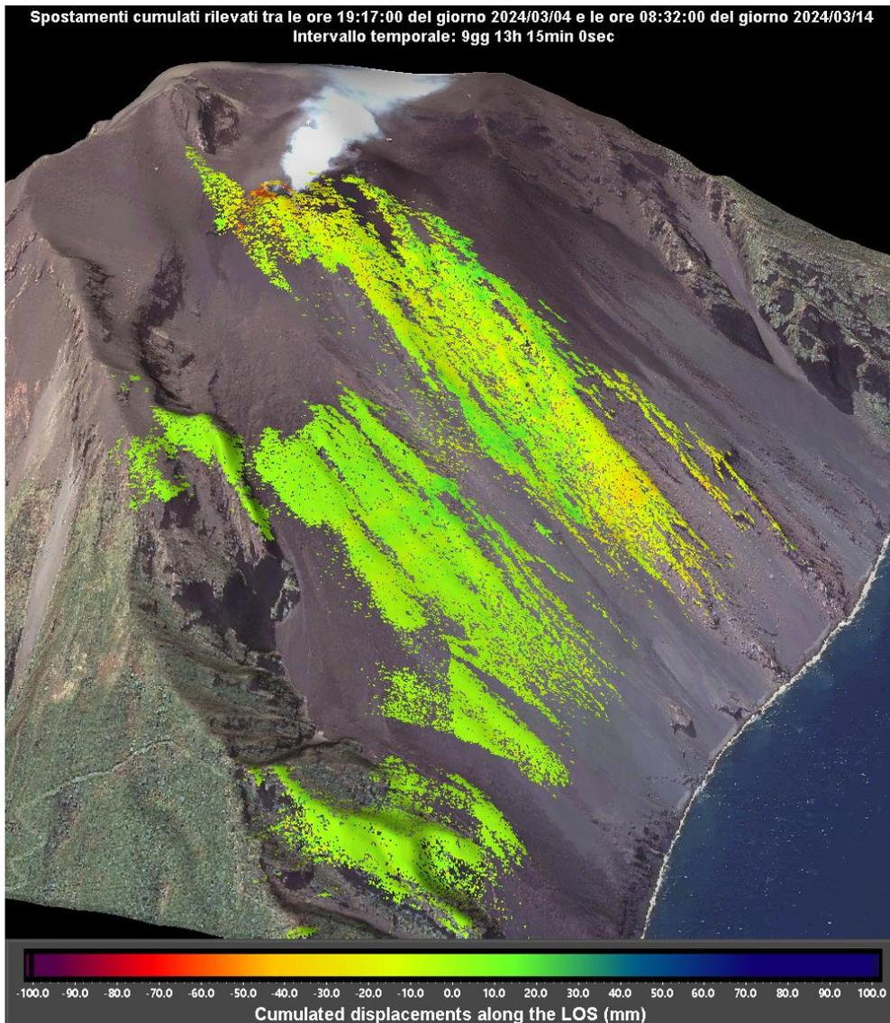
**Figura 2 –** Mappa degli spostamenti cumulati registrati dal sistema GBInSAR NE190 riferito al tempo di 9 giorni 3 ore e 15 minuti dalle ore 19:17 UTC (20:17 ora locale) del 04 marzo 2024 alle ore 08:32 UTC (09:32 ore locali) del 14 marzo 2024.
