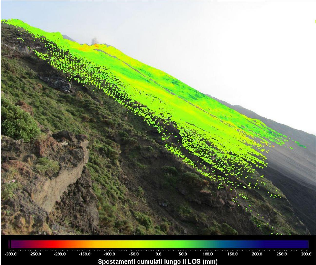
**Figura 2 – Mappa degli spostamenti cumulati registrati dal sistema GBInSAR NE190 riferito al tempo di 30 giorni e 1 minuti dalle ore 08:55 UTC (10:55 ora locale) del 30 maggio 2023 alle ore 08:56 UTC (10:56 ore locali) del 29 giugno 2023.**
