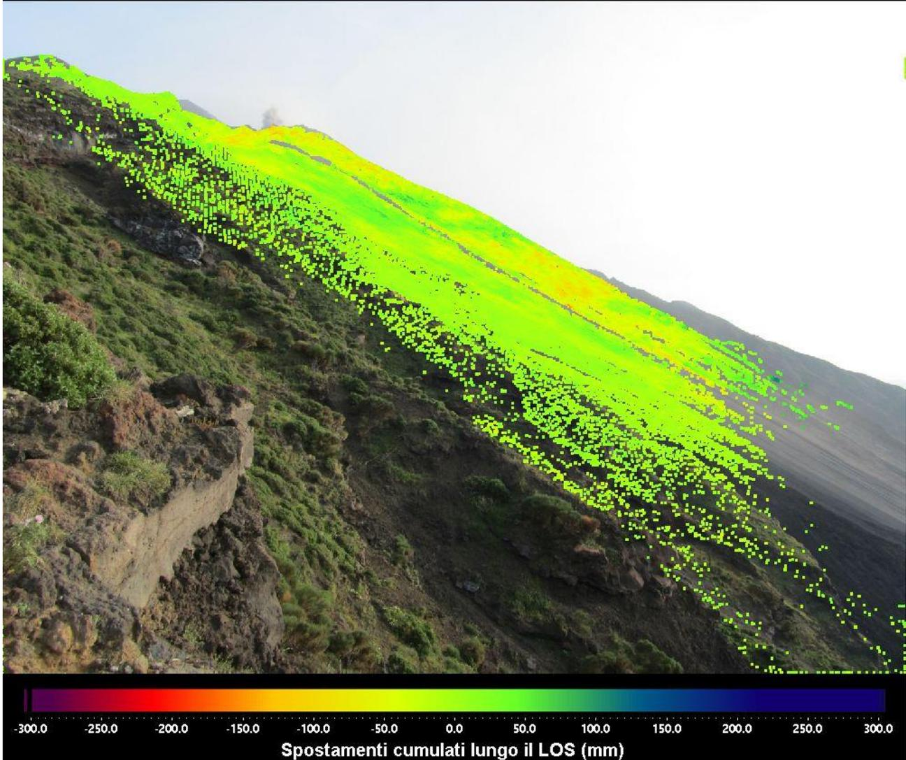
**Figura 2 – Mappa degli spostamenti cumulati registrati dal sistema GBInSAR NE190 riferito al tempo di 30 giorni e 2 minuti dalle ore 08:46 UTC (10:46 ora locale) del 23 maggio 2023 alle ore 08:48 UTC (10:48 ore locali) del 22 giugno 2023.**
