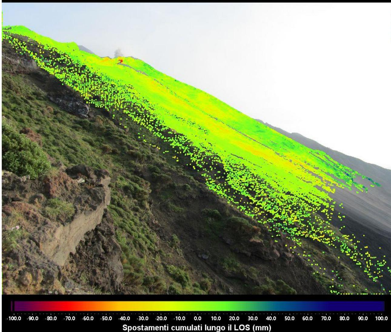
Figura 2 – Spostamento cumulato registrato dal sistema GBInSAR NE190 riferito al tempo di 7 giorni e 8 minuti dalle ore 14:32 UTC (16:32 ora locale) del 13 aprile 2023 alle ore 14:40 UTC (16:40 ore locali) del 20 aprile 2023.
