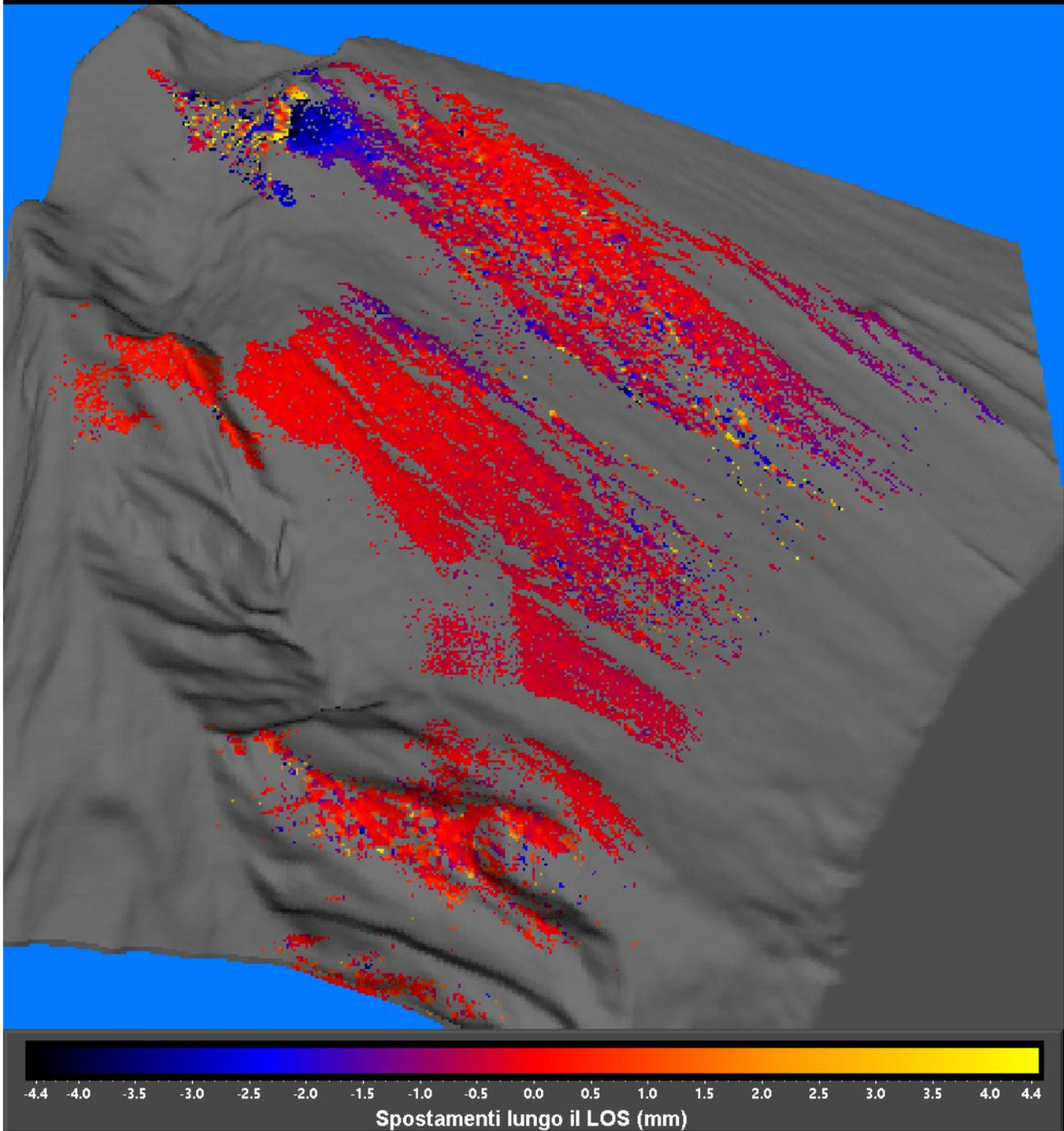
**Figura 2 – Interferogramma registrato dal sistema GBInSAR NE190 riferito al tempo di 3 giorni e 9 minuti dalle ore 08:42 UTC (10:42 ora locale) del 27 marzo 2023 alle ore 08:51 UTC (10:51 ore locali) del 30 marzo 2023.**
