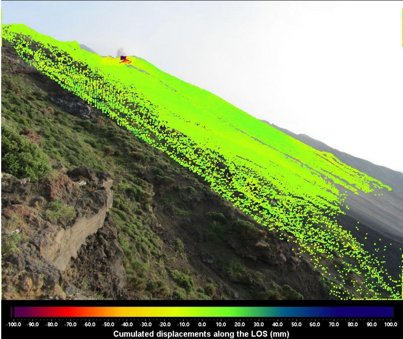
Figura 2 – Spostamento cumulato registrato dal sistema GBInSAR NE190 riferito al tempo di 7 giorni e 19 minuti dalle ore 09:25 UTC (10:25 ora locale) del 05 gennaio 2022 alle ore 09:44 UTC (10:44 ore locali) del 12 gennaio 2023.
