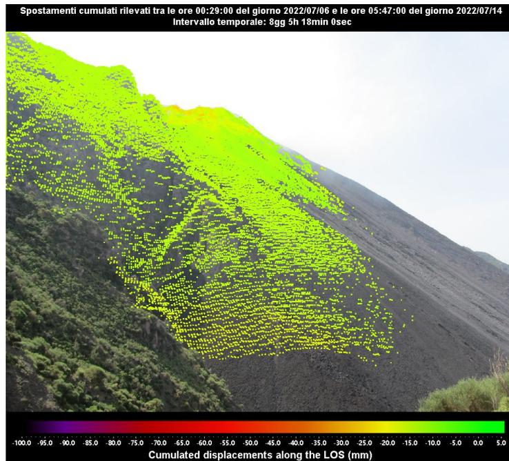
**Figura 2 - Mappa degli spostamenti cumulati registrata dal sistema GBInSAR NE400 riferita al tempo di 8 giorni, 5 ore e 18 minuti dalle ore 00:29 UTC (02:29 ora locale) del 06 luglio 2022 alle ore 05:47 UTC (07:47 ore locali) del 14 luglio 2022.**
