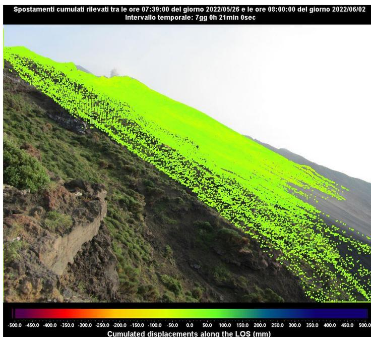
**Figura 3 -** Mappa degli spostamenti cumulati registrata dal sistema GBInSAR NE190 riferita al tempo di 7 giorni e 21 minuti dalle ore 07:39 UTC (09:39 ore locali) del 26 maggio 2022 alle ore 08:00 UTC (10:00 ore locali) del 02 giugno 2022.
