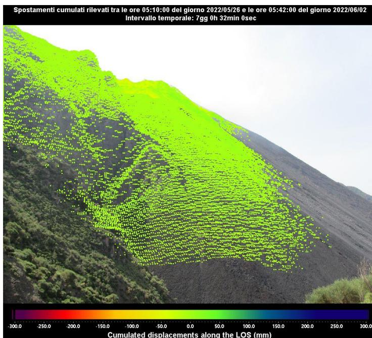
**Figura 2 -** Mappa degli spostamenti cumulati registrata dal sistema GBInSAR NE400 riferita al tempo di 7 giorni e 32 minuti dalle ore 05:10 UTC (07:10 ore locali) del 26 maggio 2022 alle ore 05:42 UTC (07:42 ore locali) del 02 giugno 2022.
