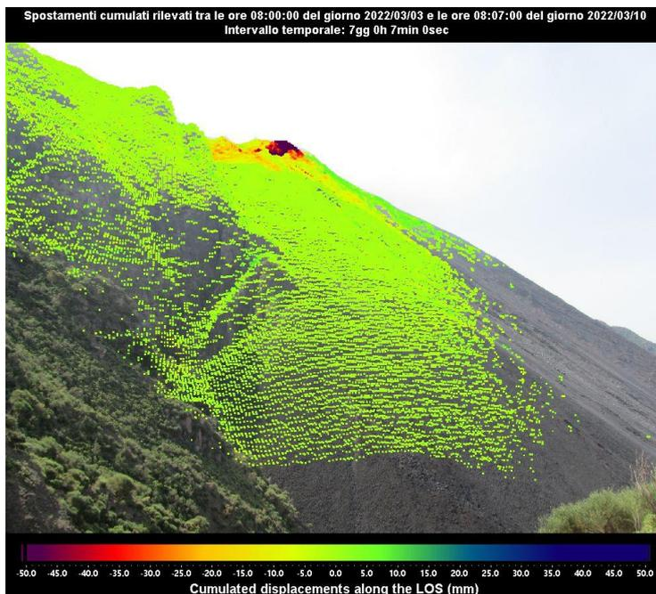
Figura 2 - Mappa degli spostamenti cumulati registrata dal sistema GBInSAR NE400 riferita al tempo di 7 giorni, 7 minuti dalle ore 08:00 UTC (09:00 ore locali) del 3 marzo 2022 alle ore 08:07 UTC (09:07 ore locali) del 10 marzo 2022.
