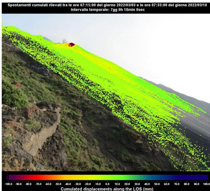
Figura 3 - Mappa degli spostamenti cumulati registrata dal sistema GBInSAR NE190 riferita al tempo di 7 giorni e 18 minuti dalle ore 07:15 UTC (08:15 ore locali) del 3 marzo 2022 alle ore 07:33 UTC (08:33 ore locali) del 10 marzo 2022.
