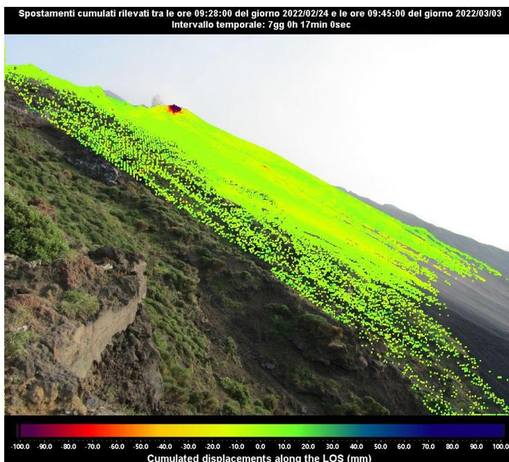
**Figura 3 - Mappa degli spostamenti cumulati registrata dal sistema GBInSAR NE190 riferita al tempo di 7 giorni e 17 minuti dalle ore 09:28 UTC (10:28 ore locali) del 24 febbraio 2022 alle ore 09:45 UTC (10:45 ore locali) del 3 marzo 2022.**
