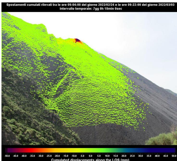
**Figura 2 - Mappa degli spostamenti cumulati registrata dal sistema GBInSAR NE400 riferita al tempo di 7 giorni, 18 minuti dalle ore 09:04 UTC (10:04 ore locali) del 24 febbraio 2022 alle ore 09:22 UTC (10:22 ore locali) del 3 marzo 2022.**
