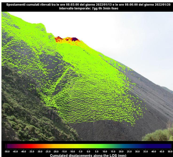
**Figura 2 -** Mappa degli spostamenti cumulati registrata dal sistema GB-InSAR NE400 riferita al tempo di 7 giorni, 3 minuti dalle ore 08:03 UTC (10:03 ore locali) del 13 gennaio 2022 alle ore 08:06 UTC (10:06 ore locali) del 20 gennaio 2022.
