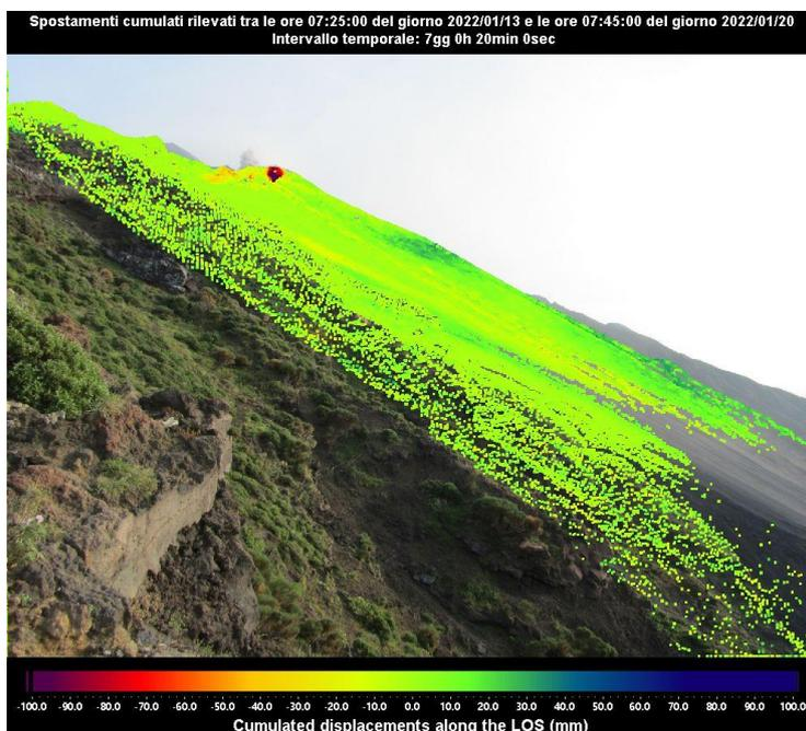
**Figura 3 -** Mappa degli spostamenti cumulati registrata dal sistema GB-InSAR NE190 riferita al tempo di 7 giorni e 20 minuti dalle ore 07:25 UTC (08:25 ore locali) del 13 gennaio 2022 alle ore 07:45 UTC (08:45 ore locali) del 20 gennaio 2022.
