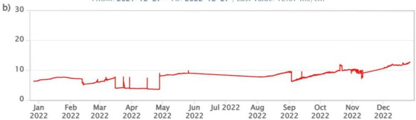
**Fig. 8.1** *Fig. 8.1 Dati di temperatura e conducibilità riferita a 20°C acquisiti in automatico nel pozzo C. Sicilia.*
