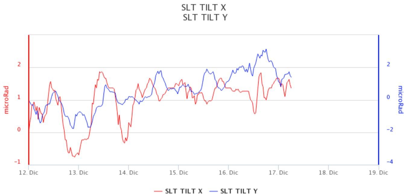
**Fig. 12.1** Serie temporale delle componenti Radiale (X) e Tangenziale (Y) del clinometro di SLT dell'ultima settimana. A causa di un problema informatico, i dati sono aggiornati al 17 u.s.
