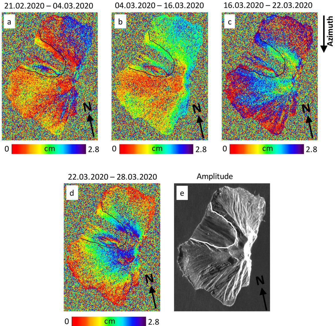
Figura 3. Interferogrammi differenziali, in geometria radar, generati a partire da dati acquisiti lungo orbite discendenti dai sensori Sentinel-1. a-d) Interferogrammi consecutivi a 6 o 12 giorni (in base alla disponibilità delle acquisizioni) a partire dall'acquisizione del 21 febbraio 2020 fino a quella del 28 marzo 2020. e) immagine SAR di ampiezza per raffronto spaziale. In nero o bianco sono indicati i confini della Sciara del Fuoco, per riferimento.
