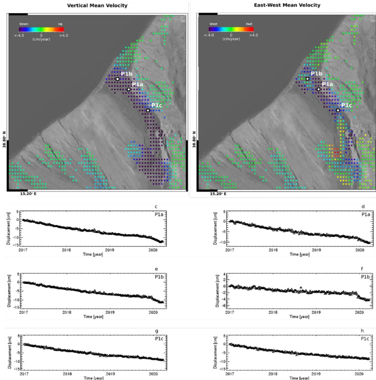
Figura 2. Mappe delle componenti Verticale ed Est-Ovest della velocità media di deformazione dell'area settentrionale della Sciara del Fuoco relative al periodo 24 aprile 2015 – 22 marzo 2020. a) Componente Verticale. b) Componente Est-Ovest. c-h) Andamento temporale della deformazione lungo la direzione Verticale (c)(e)(g) ed Est-Ovest (d)(f)(h) in corrispondenza di tre punti identificati come P1a, P1b e P1c in (a)-(b) nel periodo gennaio 2017 – marzo 2020.
