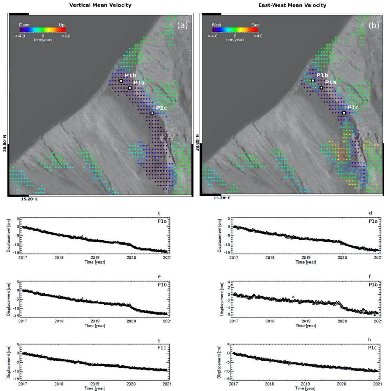
Figura 2. Mappe delle componenti Verticale ed Est-Ovest della velocità media di deformazione dell'area settentrionale della Sciara del Fuoco relative al periodo 24 aprile 2015 – 23 dicembre 2020. a) Componente Verticale. b) Componente Est-Ovest. c-h) Andamento temporale della deformazione lungo la direzione Verticale (c)(e)(g) ed Est-Ovest (d)(f)(h) in corrispondenza di tre punti identificati come P1a, P1b e P1c in (a)-(b) nel periodo gennaio 2017 – dicembre 2020.
