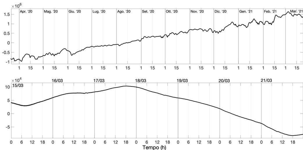
**Fig. 4.4** - Grafico relativo al dato dilatometrico registrato a SVO: in alto viene mostrato lo strain registrato dal 21/03/2020, in basso quello nell'ultima settimana.
