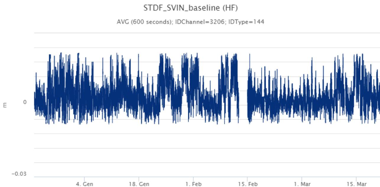
**Fig. 5.1** - Serie temporale della variazione di distanza tra le stazioni GNSS di SVIN e di STDF. Scala temporale: tre mesi.
