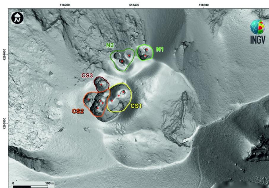
**Fig. 3.1** - Modello ombreggiato del terreno dell'area craterica realizzato dal Laboratorio HPHT di Roma 1 e dal FlyEye-Team di OE nell'ambito delle attività del progetto Dipartimentale UNO, con colori differenti sono evidenziate le differenti aree crateriche: CS 1 in giallo, CS2 in arancione, CS3 in rosso scuro; N1 verde chiaro, N2 verde scuro e con dei cerchi rossi i crateri attivi.
