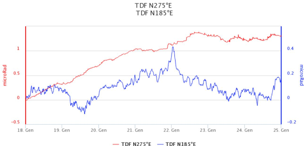
**Fig. 5.2** - Componenti X e Y (microradianti) del tilt di TDF registrate nell'ultima settimana
