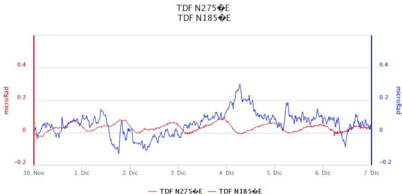
**Fig. 5.2** - Componenti X e Y del tilt di TDF
