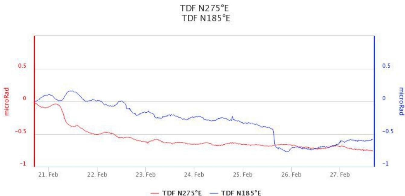
**Fig. 5.1** Serie temporali delle componenti X e Y del tilt di TDF
