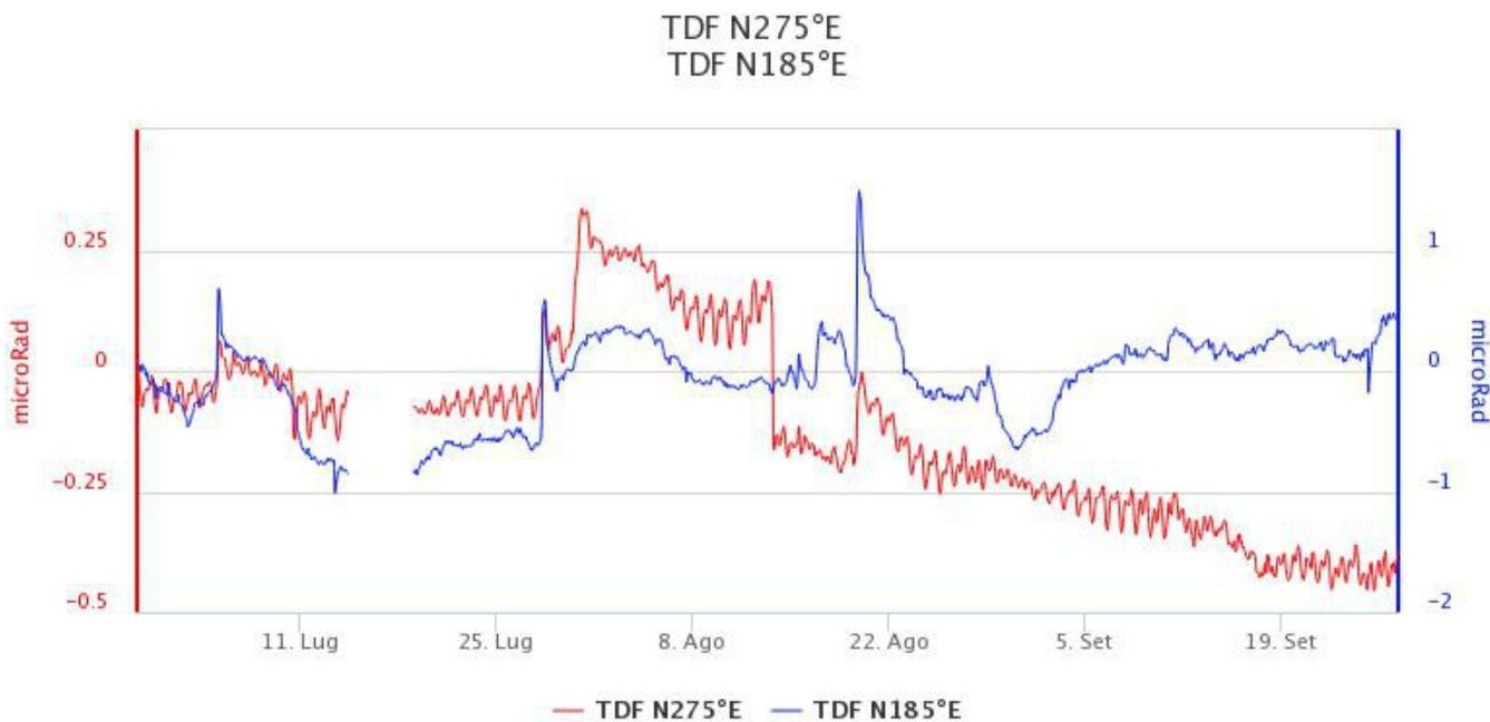
**Fig. 5.1** Serie temporali delle componenti X e Y del tilt TDF
