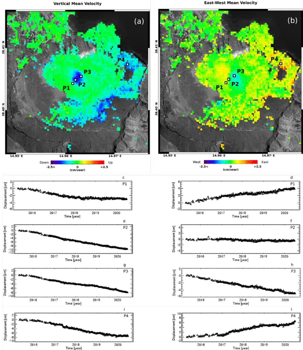
Figura 2. Vulcano – La Fossa: mappe delle componenti Verticale ed Est-Ovest della velocità media di deformazione relative al periodo 24 aprile 2015 – 20 giugno 2020 generate a partire da dati Sentinel-1. a) Componente Verticale. b) Componente Est-Ovest. c-j) Andamento temporale della deformazione lungo la direzione Verticale (c)(e)(g)(i) ed Est-Ovest (d)(f)(h)(j) in corrispondenza di quattro punti identificati come P1, P2, P3 e P4 in (a)-(b).
