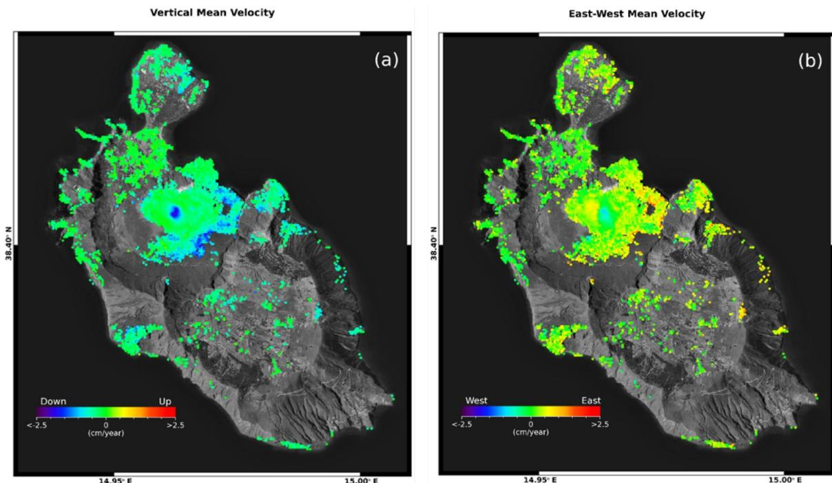
Figura 1. Vulcano: mappe delle componenti Verticale ed Est-Ovest della velocità media di deformazione relative al periodo 24 aprile 2015 – 20 giugno 2020 generate a partire da dati Sentinel-1. a) Componente Verticale. b) Componente Est-Ovest.
