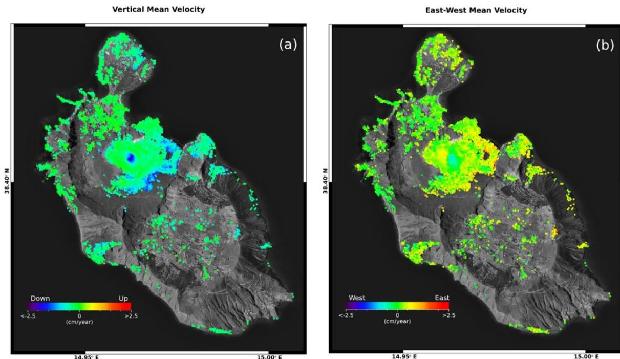
Figura 1. Vulcano: mappe delle componenti Verticale ed Est-Ovest della velocità media di deformazione relative al periodo 24 aprile 2015 – 14 luglio 2020 generate a partire da dati Sentinel-1. a) Componente Verticale. b) Componente Est-Ovest.
