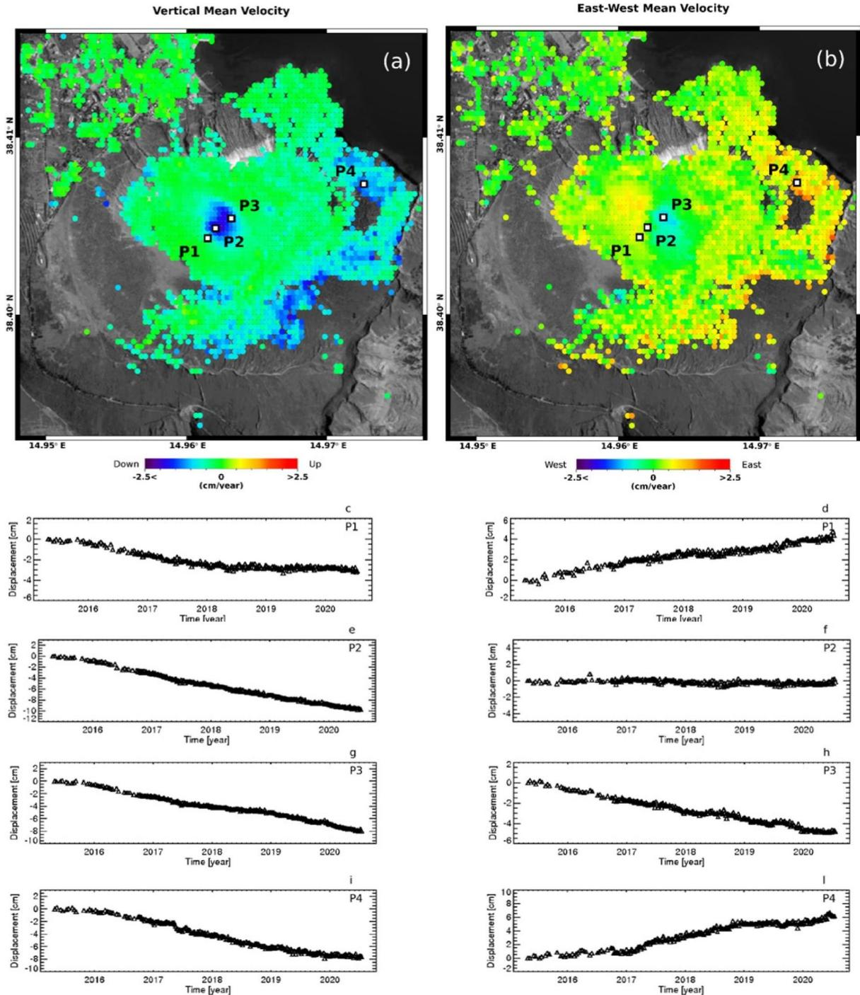
Figura 2. Vulcano – La Fossa: mappe delle componenti Verticale ed Est-Ovest della velocità media di deformazione relative al periodo 24 aprile 2015 – 14 luglio 2020 generate a partire da dati Sentinel-1. a) Componente Verticale. b) Componente Est-Ovest. c-j) Andamento temporale della deformazione lungo la direzione Verticale (c)(e)(g)(i) ed Est-Ovest (d)(f)(h)(j) in corrispondenza di quattro punti identificati come P1, P2, P3 e P4 in (a)-(b).
