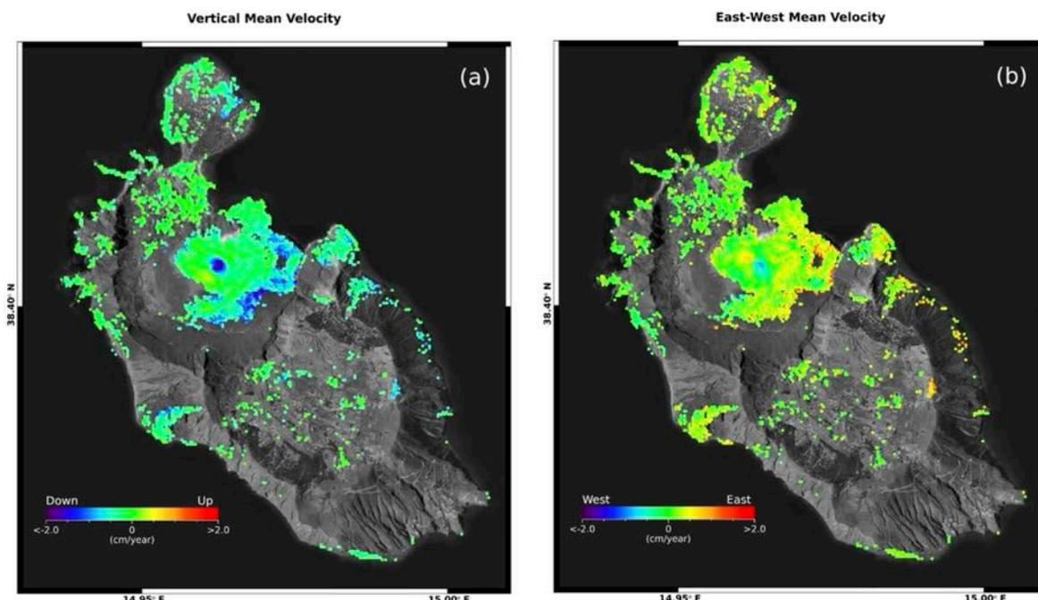
Figura 1. Vulcano: mappe delle componenti Verticale ed Est-Ovest della velocità media di deformazione relative al periodo 24 aprile 2015 – 7 dicembre 2022 generate a partire da dati Sentinel-1. a) Componente Verticale. b) Componente Est-Ovest.
