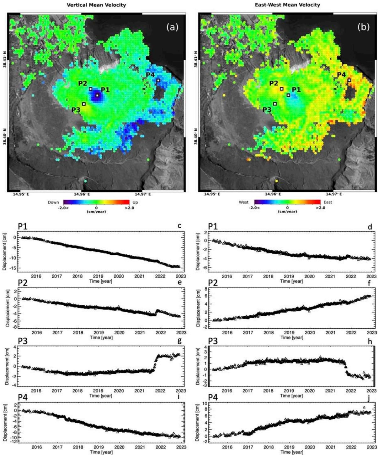
Figura 2. Vulcano – La Fossa: mappe delle componenti Verticale ed Est-Ovest della velocità media di deformazione relative al periodo 24 aprile 2015 – 7 dicembre 2022 generate a partire da dati Sentinel-1. a) Componente Verticale. b) Componente Est-Ovest. c-j) Andamento temporale della deformazione lungo la direzione Verticale (c)(e)(g)(i) ed Est-Ovest (d)(f)(h)(j) in corrispondenza di quattro punti identificati come P1, P2, P3 e P4 in (a)-(b).
