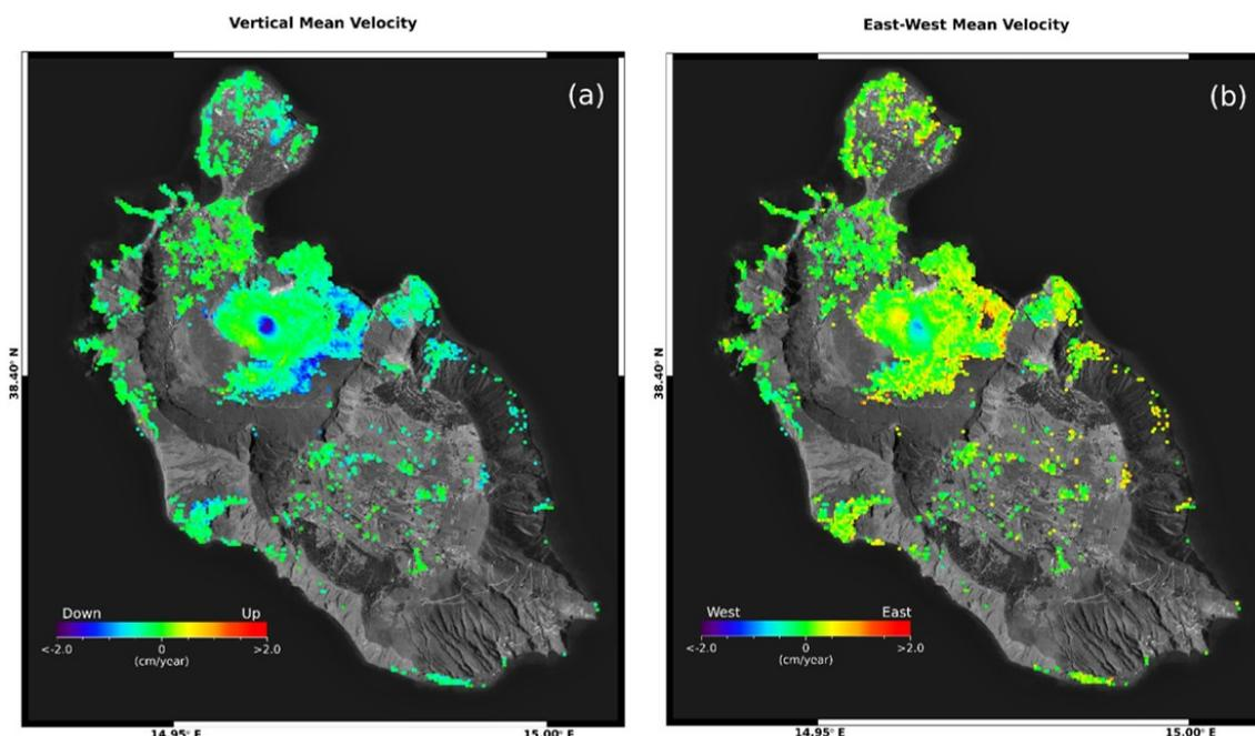
Figura 1. Vulcano: mappe delle componenti Verticale ed Est-Ovest della velocità media di deformazione relative al periodo 24 aprile 2015 – 4 febbraio 2022 generate a partire da dati Sentinel-1. a) Componente Verticale. b) Componente Est-Ovest.
