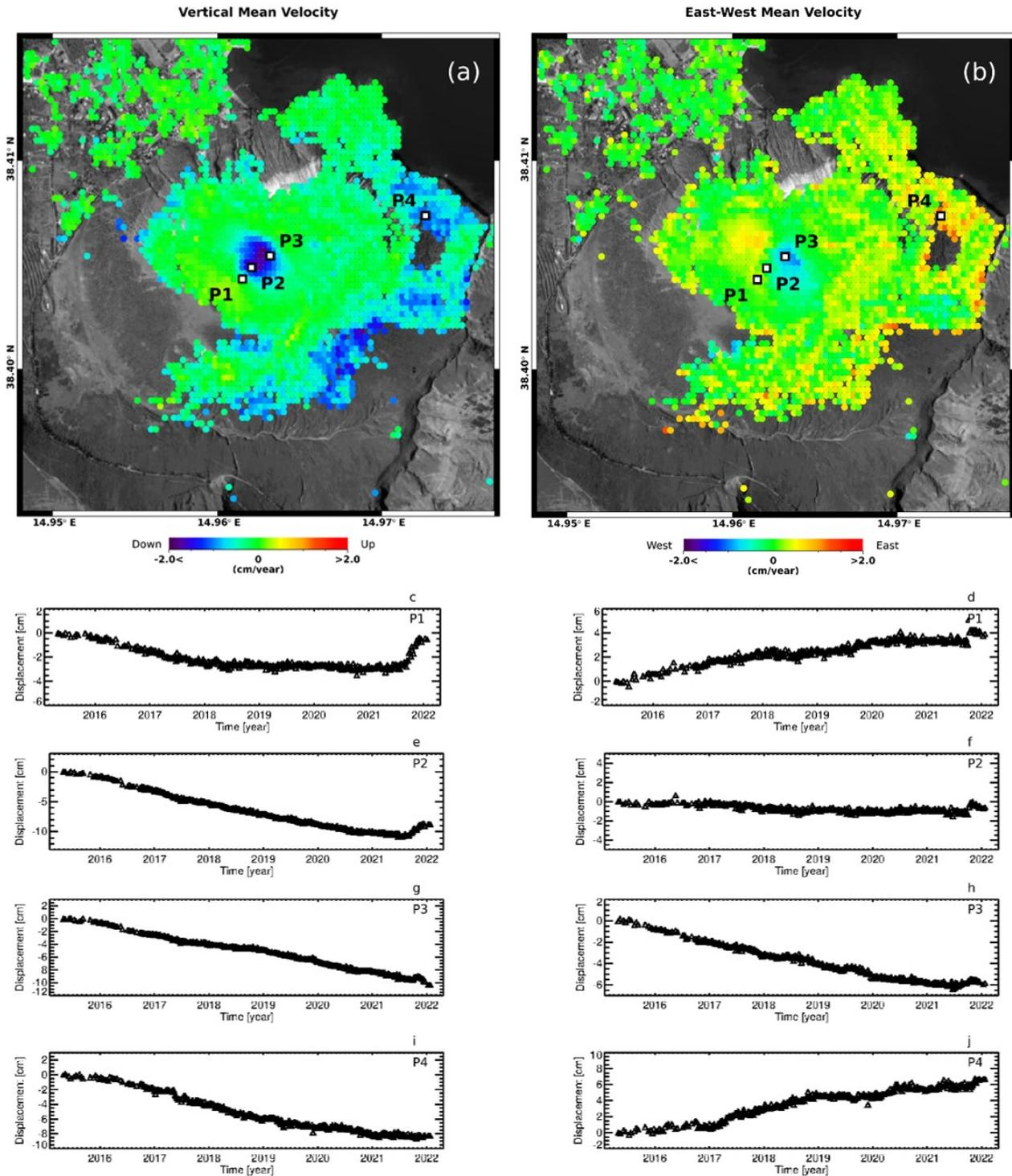
Figura 2. Vulcano – La Fossa: mappe delle componenti Verticale ed Est-Ovest della velocità media di deformazione relative al periodo 24 aprile 2015 – 4 febbraio 2022 generate a partire da dati Sentinel-1. a) Componente Verticale. b) Componente Est-Ovest. c-j) Andamento temporale della deformazione lungo la direzione Verticale (c)(e)(g)(i) ed Est-Ovest (d)(f)(h)(j) in corrispondenza di quattro punti identificati come P1, P2, P3 e P4 in (a)-(b).
