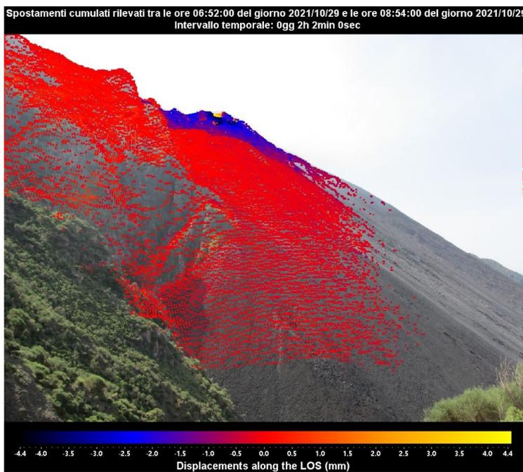
**Figura 2 - Interferogramma registrato dal sistema GB-InSAR NE400 riferito al tempo di 2 ore e 2 minuti dalle ore 06:52 UTC (08:52 ore locali) alle ore 08:54 UTC (11:54 ore locali) del 28 ottobre 2021.**
