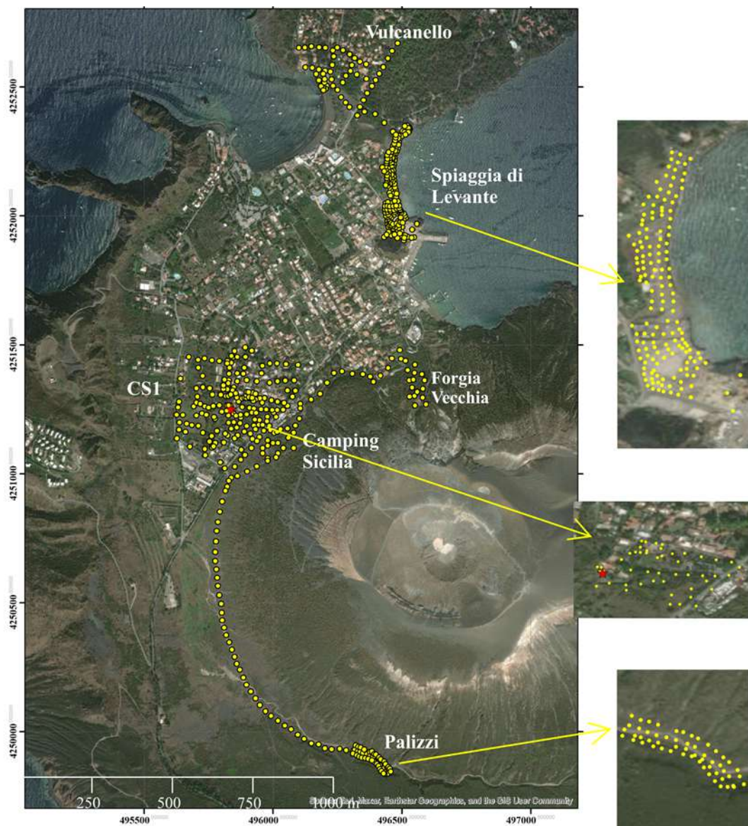
Fig. 1. Ubicazione delle misure del flusso di CO 2 dal suolo eseguite nella campagna di settembre 2022. CS1: area target allargata di Camping Sicilia. Stella rossa: stazione di monitoraggio della concentrazione di CO 2 nel suolo.
