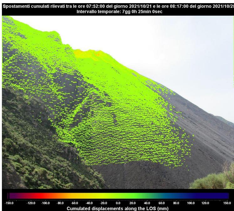
**Figura 2 - Mappa cumulata degli spostamenti registrata dal sistema GB-InSAR NE400 riferito al tempo di 7 giorni e 25 minuti dalle ore 07:52 UTC (09:52 ore locali) del 21 ottobre 2021 alle ore 08:17 UTC (10:17 ore locali) del 28 ottobre 2021.**
