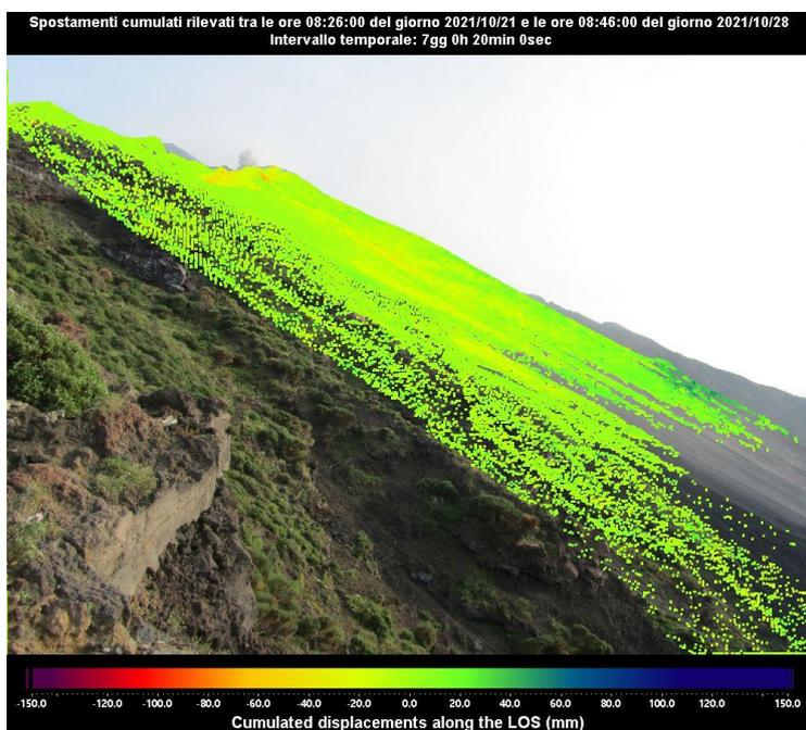
**Figura 3 - Mappa cumulata degli spostamenti registrata dal sistema GB-InSAR NE190 riferito al tempo di 7 giorni e 20 minuti dalle ore 08:26 UTC (10:26 ore locali) del 21 ottobre 2021 alle ore 08:46 UTC (10:46 ore locali) del 28 ottobre 2021.**
