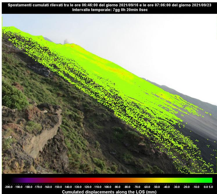
**Figura 3 -** Mappa degli spostamenti cumulati registrati dal sistema GB-InSAR NE190 riferito al tempo di 7 giorni e 20 minuti, dalle ore 06:45 UTC (08:45 ore locali) del 16 settembre 2021 alle ore 07:06 UTC (09:06 ore locali) del 23 settembre 2021.
