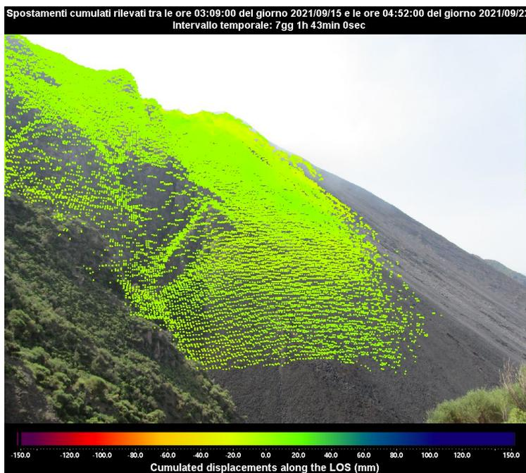
**Figura 2 -** Mappa degli spostamenti cumulati registrati dal sistema GB-InSAR NE400 riferito al tempo di 7 giorni e 43 minuti, dalle ore 03:09 UTC (05:09 ore locali) del 15 settembre 2021 alle ore 04:52 UTC (06:52 ore locali) del 22 settembre 2021.
