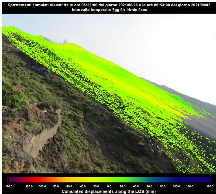
**Figura 3 -** Mappa degli spostamenti cumulati registrati dal sistema GB-InSAR NE190 riferito al tempo di 7 giorni e 14 minuti, dalle ore 06:39 UTC (08:39 ore locali) del 26 agosto 2021 alle ore 06:53 UTC (08:53 ore locali) del 2 settembre 2021.
