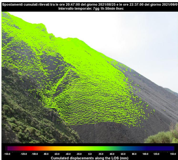
**Figura 2 -** Mappa degli spostamenti cumulati registrati dal sistema GB-InSAR NE400 riferito al tempo di 7 giorni, 1 ora e 50 minuti, dalle ore 20:47 UTC (22:47 ore locali) del 25 agosto 2021 alle ore 22:37 UTC del 1 settembre 2021 (00:37 ore locali del 2 settembre 2021).
