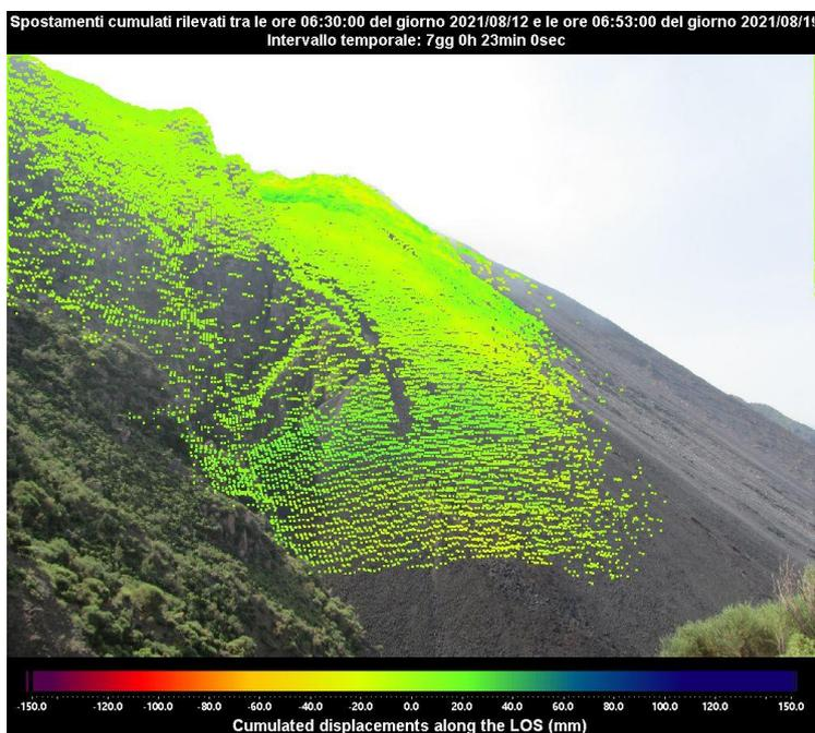
**Figura 2 -** Mappa degli spostamenti cumulati registrati dal sistema GB-InSAR NE400 riferito al tempo di 7 giorni e 23 minuti, dalle ore 06:30 UTC (08:30 ore locali) del 12 agosto 2021 alle ore 06:53 UTC (08:53 ore locali) del 19 agosto 2021.
