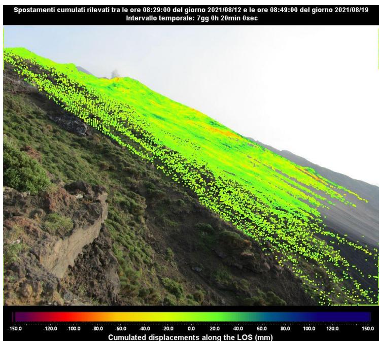
**Figura 3 -** Mappa degli spostamenti cumulati registrati dal sistema GB-InSAR NE190 riferito al tempo di 7 giorni e 20 minuti, dalle ore 08:2 UTC (10:29 ore locali) del 12 agosto 2021 alle ore 08:49 UTC (10:49 ore locali) del 19 agosto 2021.
