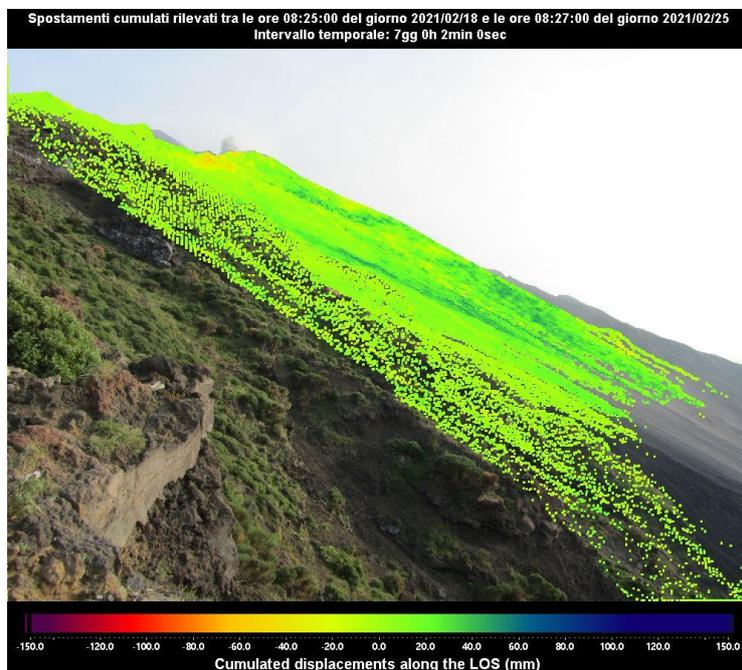
Figura 3 - Mappa degli spostamenti cumulati registrati dal sistema GB-InSAR NE190 riferito al tempo di 7 giorni e 2 minuti, dalle ore 08:25 UTC (09:25 ore locali) del 18 febbraio 2021 alle ore 08:27 UTC (09:27 ore locali) del 25 febbraio 2021.
