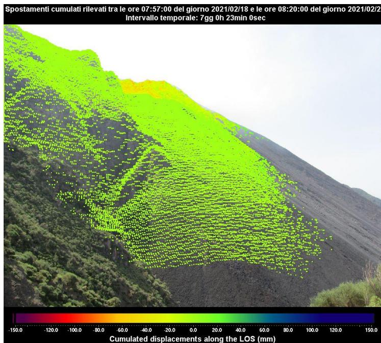
Figura 2 - Mappa degli spostamenti cumulati registrati dal sistema GB-InSAR NE400 riferito al tempo di 7 giorni e 23 minuti, dalle ore 07:57 UTC (08:57 ore locali) del 18 febbraio 2021 alle ore 08:20 UTC (09:20 ore locali) del 25 febbraio 2021.
