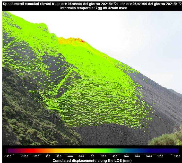
Figura 2 - Mappa degli spostamenti cumulati registrati dal sistema GB-InSAR NE400 riferito al tempo di 7 giorni e 32 minuti, dalle ore 06:09 UTC (07:09 ore locali) del 21 gennaio 2021 alle ore 06:41 UTC (07:41 ore locali) del 28 gennaio 2021.
