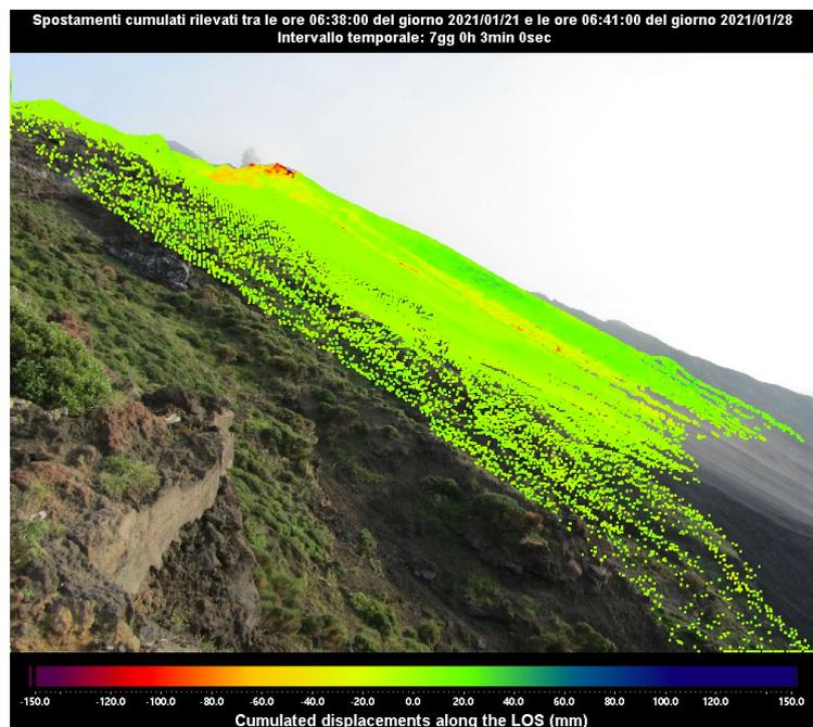
Figura 3 - Mappa degli spostamenti cumulati registrati dal sistema GB-InSAR NE190 riferito al tempo di 7 giorni e 3 minuti, dalle ore 06:38 UTC (07:38 ore locali) del 21 gennaio 2021 alle ore 06:41 UTC (07:41 ore locali) del 28 gennaio 2021.
